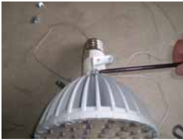
金具の先端を切断加工し、ビス仮止め
