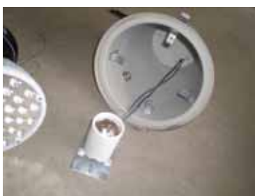
LEDに口金を取付ける。 柱)口金の+と-を間違わないように
