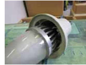
灯具にLED取付完了
